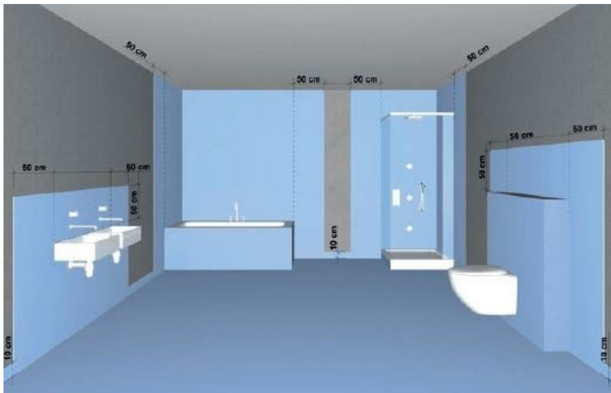
Rys. 1 Strefy wykonania hydroizolacji
